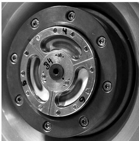
Abbildung 9. Foto des ARTESIA-Target-Rads mit drei ^{248}\text{Cm} -Targets. Die drei länglichen dunklen Flecke zeigen das Gebiet, das von der ersten Fraktion der Strahlteilchen getroffen wurde, bevor später die gesamte Target-Fläche (weiße Oberfläche) „eingebacken“ wurde.
